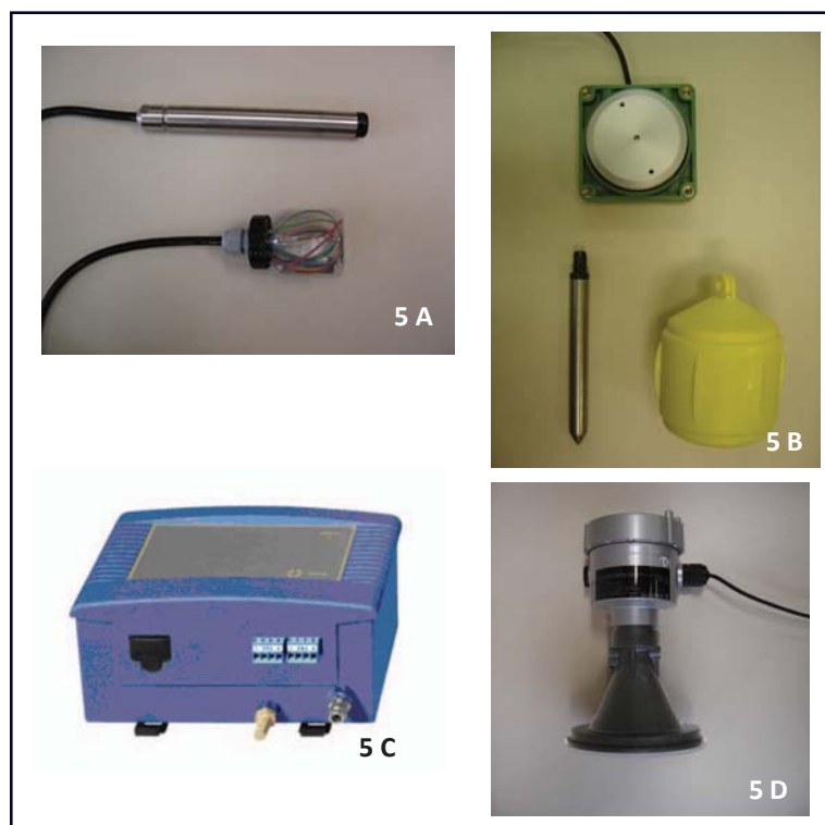
Figura 5. Alguns tipos de sensor disponíveis no mercado, de diferentes fabricantes, utilizados para determinação do nível de água: (A) transdutor de pressão; (B) flutuador e contrapeso; (C) pressão por borbulhamento; (D) radar
