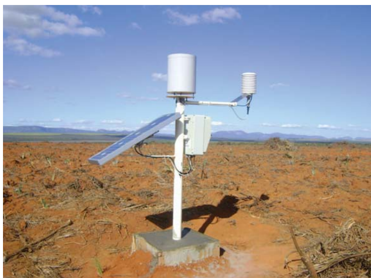
Figura 12. Imagem de uma estação agrometeorológica típica com pluviômetro automático, painel solar, sensores de temperatura, umidade relativa, molhamento foliar e o datalogger
